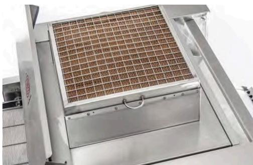
Catalyseur permettant de brûler les graisses contenues dans les fumées
